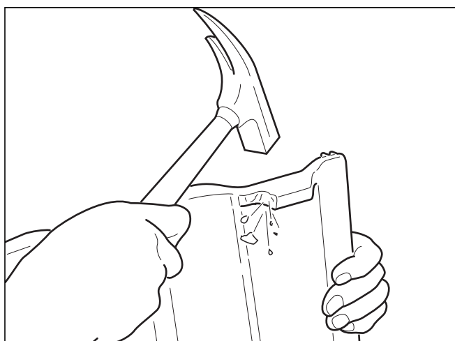
Рис. 3.34 Если Вы кладете черепицу на боковые щитки, при необх. сбейте борттик для вставки, просверлите черепицу и привинтите к планке (не к щитку).
