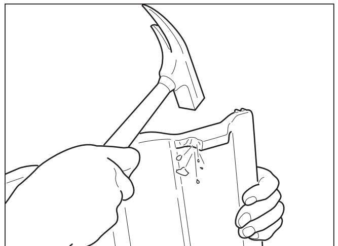
Мал. 3.34 Якщо ви кладете черепицю на бокові щитки, при необхідності збийте бортик для вставки, просвердліть черепицю та пригвинтіть до планки (не до щитка).
